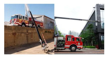
■刺穿针:兼具刺穿功能及消防灭火功能,用于对火灾内部实施精 准、快速的灭火救援。刺针可有效精准的刺穿:≥4.5mm铝板,≥3mm 钢板,≥25mm玻璃以及≥22mm木板。此外,刺针头可连接40接口水 袋,使消防救援人员对火灾内部实施点对点精准灭火。
