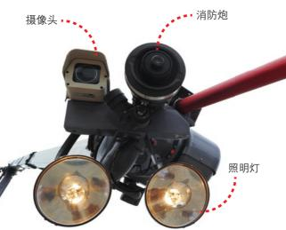
■Can Bus总线遥控操作系统: 此系统可使无线遥控距离达到120米,该遥控距离可将普通消防车的危险等级由8-9级降为2级,从而保证在复杂火场,消防员可在一定的安全距离内实施灭火作业。此外,消防员可利用遥控系统快速、精准的操控刺穿臂进入指定火情位置实施灭火作业。
