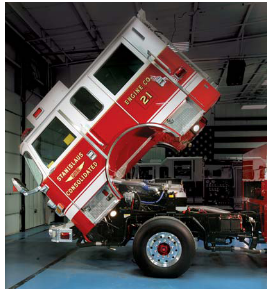
45 度整体前翻驾乘室 传动系统可轻松检修 (在起重机的辅助下可前翻 90 度)
